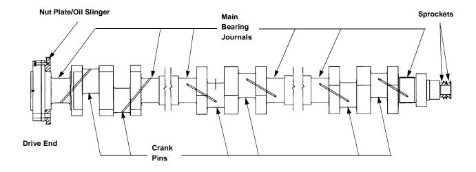
FIGURE 5-7: CRANKSHAFT - TYPICAL FLANGE (JGE/6)
