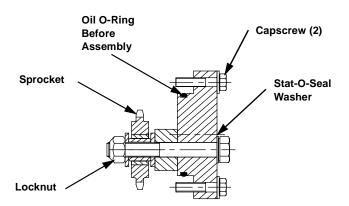
FIGURE 5-13: ECCENTRIC VERNIER - CHAIN IDLER SPROCKET (SELF-ALIGNING SPROCKET)
