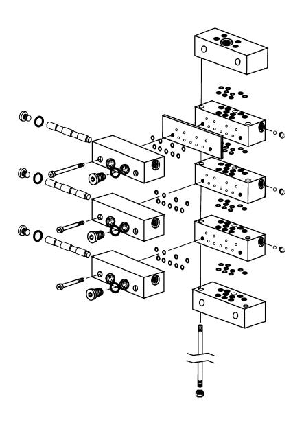
FIGURE 4-3: DIVIDER VALVES DISTRIBUTION BLOCK - TYPICAL
