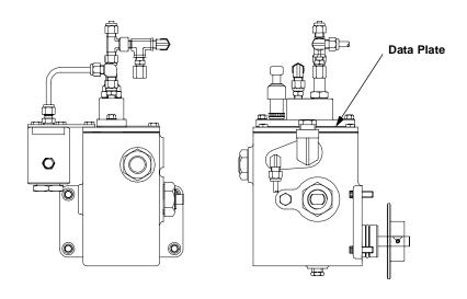
FIGURE 1-4: FORCE FEED LUBRICATOR PUMP - TYPICAL
