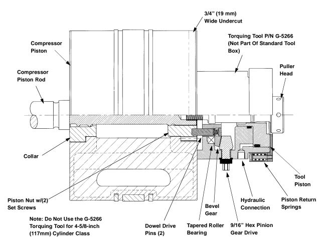
FIGURE 5-18: PISTON NUT TORQUING TOOL (P/N G-5266)
