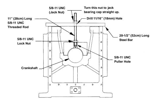
FIGURE 5-9: MAIN BEARING CAP PULLER
