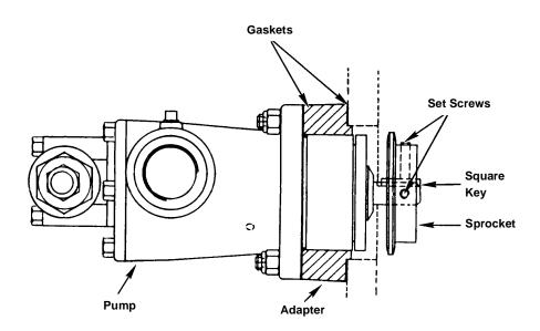
FIGURE 5-14: LUBE OIL PUMP CHAIN SPROCKET - TYPICAL
