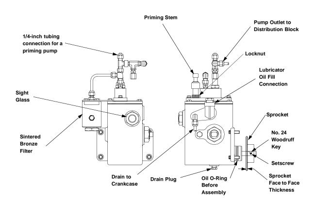
FIGURE 5-15: FORCE FEED LUBRICATOR PUMP W/ CHAIN SPROCKET - TYPICAL
