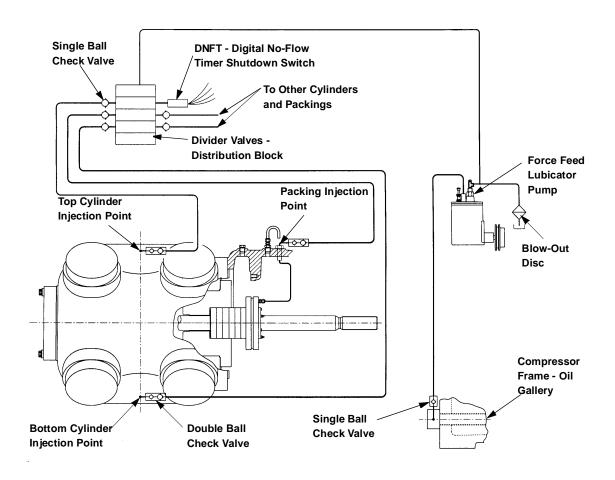
FIGURE 4-7: FORCE FEED LUBRICATION SYSTEM SCHEMATIC - TYPICAL
