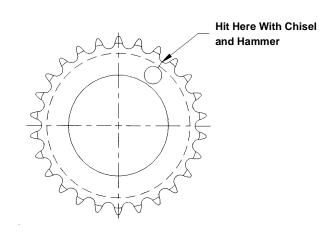
FIGURE 5-10: CRANKSHAFT CHAIN SPROCKET - TYPICAL
