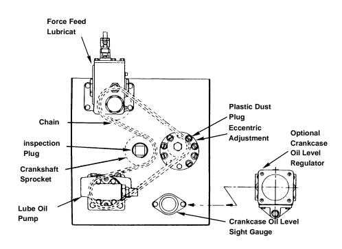
FIGURE 5-11: CHAIN DRIVE SYSTEM JGH/2/4 & JGE/2/4
