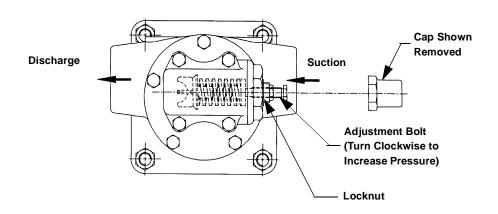
FIGURE 4-11: LUBE OIL PUMP - JGH/2/4 & JGE/2/4
